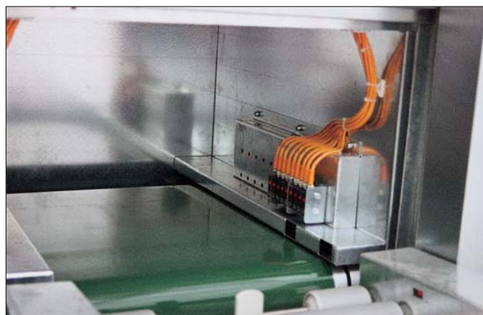
Fahrkorb mit Gurtförderer und Zielleser Driven belt and code reader in the car Benne avec transporteur et dispositif de lecture
